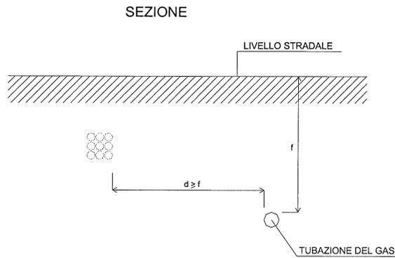
2° CASO (Non e' possibile mantenere una distanza tra i due manufatti  $\geq$  alla profondita' di posa della condotta del gas)
